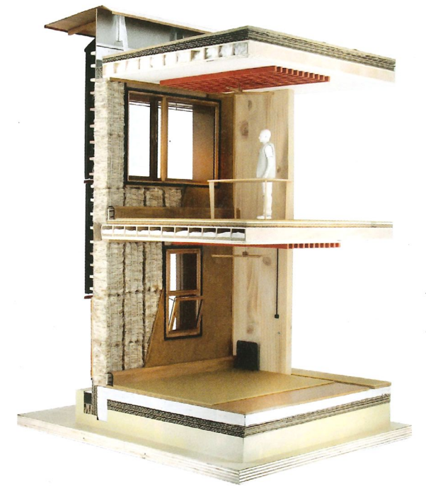
Système constructif bois-paille : Coupe d'un corps du bâtiment.
