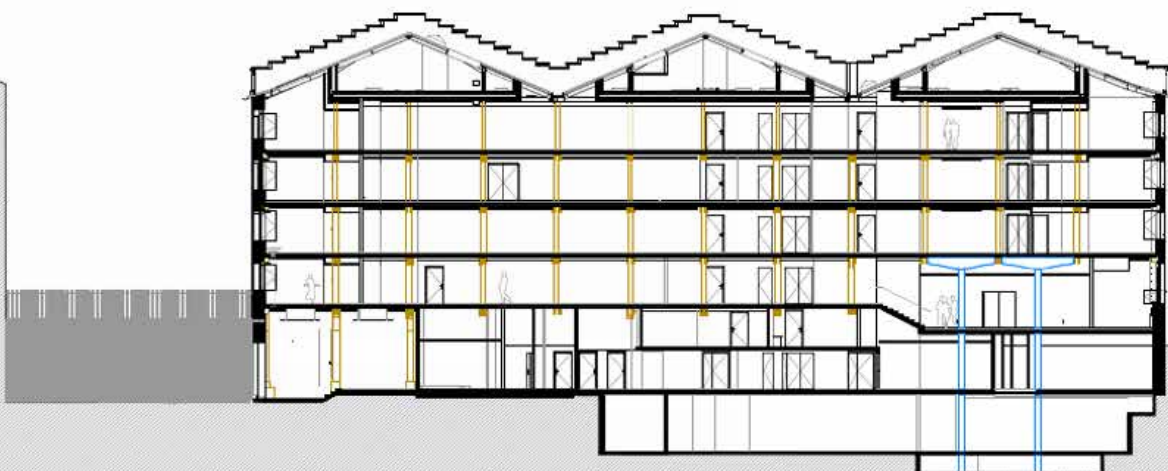
Coupe sur le projet. Les structures bois apparaissent en marron et la nouvelle structure métallique en bleu.
