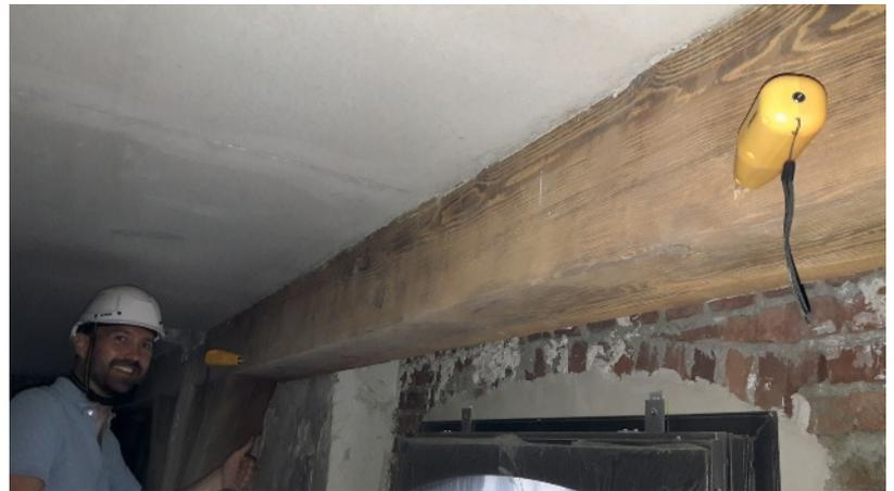
**Le Sylvatest. De 3 kg, il est passé à 300 g ! Les nouvelles versions ne mesurent plus seulement le temps de propagation des ultrasons, mais aussi l'amplitude, ce qui permet de repérer des trous, et, par exemple, de tester le lamellé-collé pour y détecter d'éventuels problèmes de collage. Désormais, un boîtier n'est plus nécessaire. La sonde sans câble auto-alimentée est capable d'envoyer les informations à une application gérée sur smartphone.**
