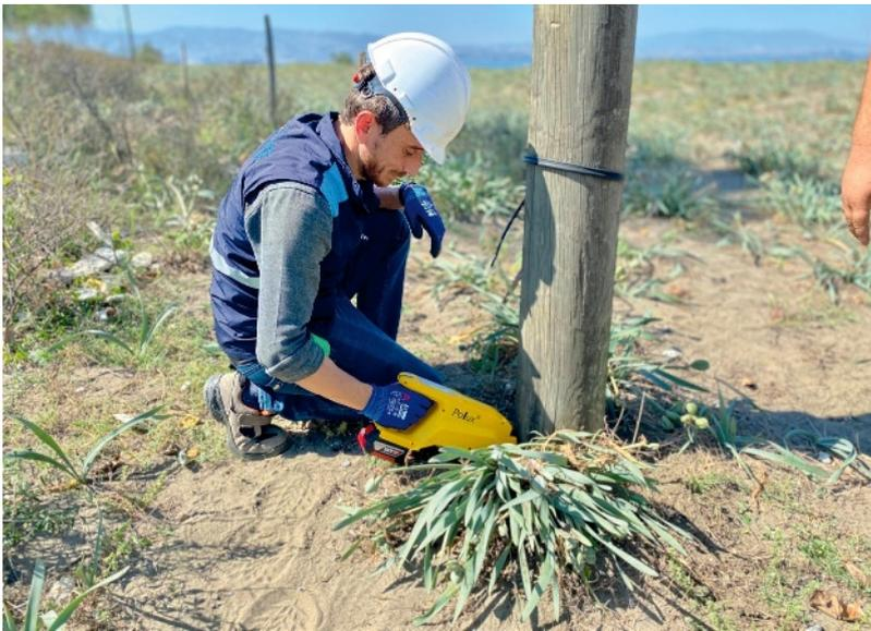
tingue trois classes de poteaux neufs : XL : poteaux aux hautes performances mécaniques, L : poteaux aux performances mécaniques élevées, S : poteaux aux performances mécaniques faibles. La fiabilité des réseaux de lignes constitués de poteaux bois peut-être assurée en purgeant les composants les plus faibles avant même leur installation sur le terrain, tandis qu'une maintenance réduite pour les plus forts est garantie.
