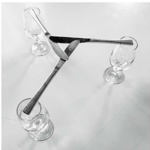
2 Principe de réciprocité structurelle: les trois couteaux sont à la fois porteurs et portés.
