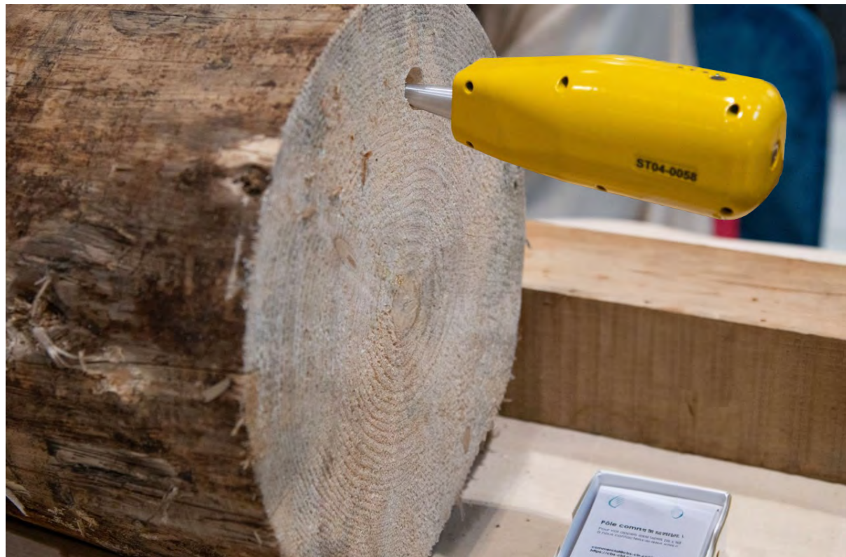
Figure 18 - Tests au SYLVATEST d'épicéa scolyté, réalisés au Forum International Bois Construction de Nancy © CBS-CBT
